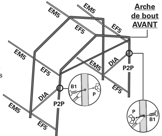
7. Assembler toutes les arches/pattes avec les entretoises mâles (EM5) en utilisant les boulons 2 1/2" (B2) et les papillons (P).
