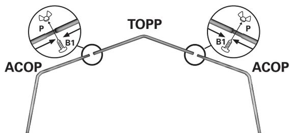
2. Insérer 2 coins d'arche (**ACO2P** pour les arches de bout) dans le centre d'arche (**TOPP**). Compléter la fixation avec un renfort d'arche (**RAP**) des boulons 1 3/4" (**B1**) et des papillons (**P**).
