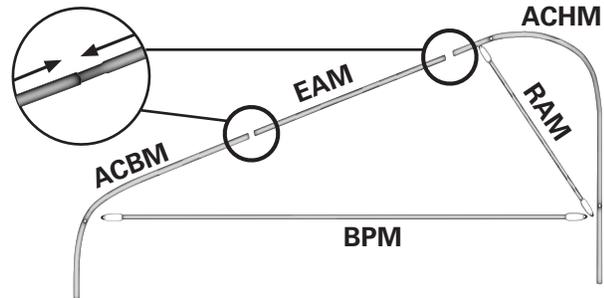
2. Ajouter une barre de porte (**BPM**) et un renfort diagonal arche (**RAM**) avec un boulon 1 3/4" (**B1**) et un papillon (**P**).
