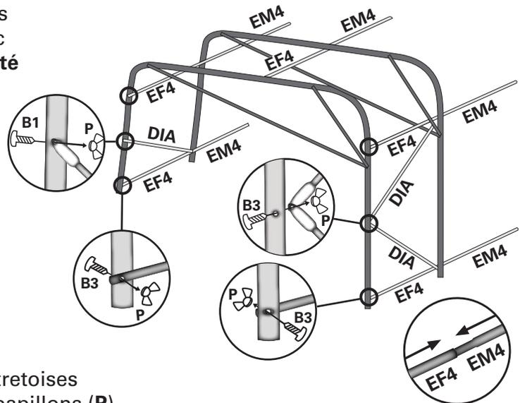
**9.** Attacher l'arche de bout AVANT avec les entretoises femelles (**EF4**) avec les boulons 3" (**B3**) et les papillons (**P**).
