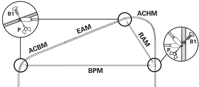
3. Compléter en installant la barre de porte (**BPM**) avec les boulons 1 3/4" (**B1**) et les papillons (**P**).
