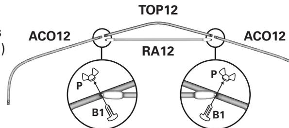
2. Insérer 2 coins d'arche (**ACO212** pour arche de bout) dans le centre d'arche (**TOP12**). Compléter les fixations avec des renforts d'arche (**RA12**), des boulons 1 3/4" (**B1**) et des papillons (**P**).
